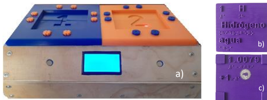
Fig.1. Componentes del tablero de Lewis. a) Tablero b) Cara frontal de la tablilla del elemento hidrógeno c) Cara posterior de la tablilla del elemento hidrógeno
