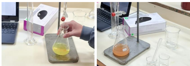
Fig.1. Punto final en la valoración de cloruros mediante el método de Mohr.
